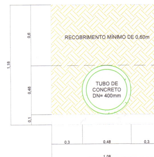
DETALHE PARA ESCAVAÇÃO E REATERRO Medidas em metro Sem escala
